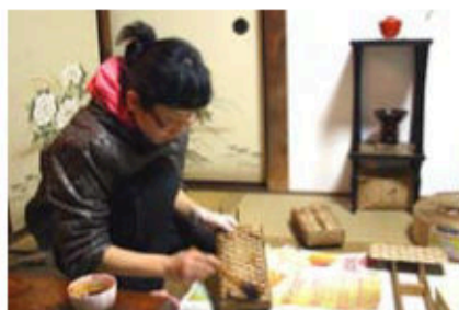
ペーパーボックスに漆を 塗る作業
